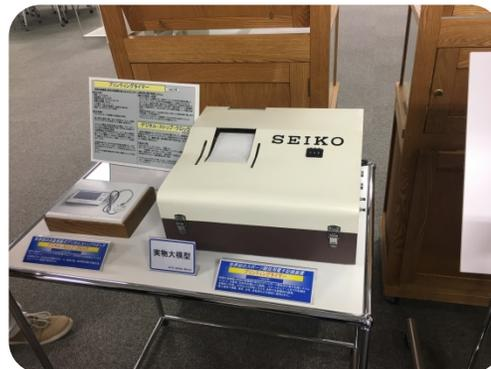
1964 год таймер Seiko со встроенным печатающим механизмом
