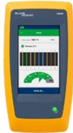
Схема разводки кабеля, Измерение длины кабеля, Расстояния до обрыва/короткого замыкания, Распарка (расщепленные пары), Генераторы сигналов аналоговый и цифровой
