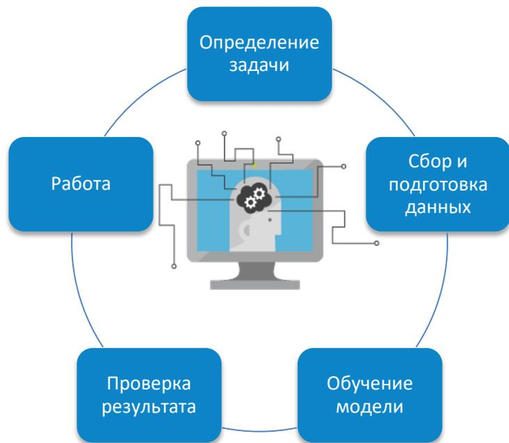
**Обучающая выборка** (training sample) — выборка, по которой производится настройка (оптимизация параметров) модели зависимости.
