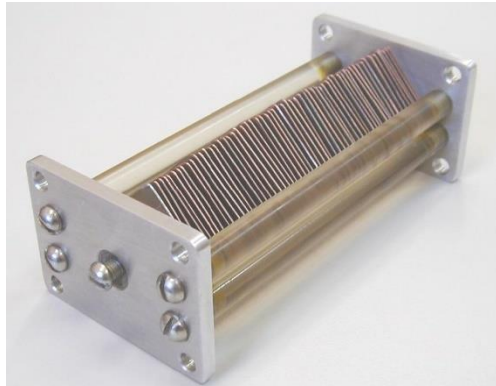
Диодная сборка SOS-180-12 (180 кВ / 12 кА / 600 г / ~ $400)
